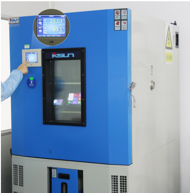
图 5-3 高低温老化测试图
